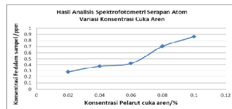
Gambar 4.2 Grafik hasil ekstraksi daun singkong menggunakan Armfield UOP4 solid-liquid extraction unit terhadap variasi konsentrasi pelarut cuka aren
